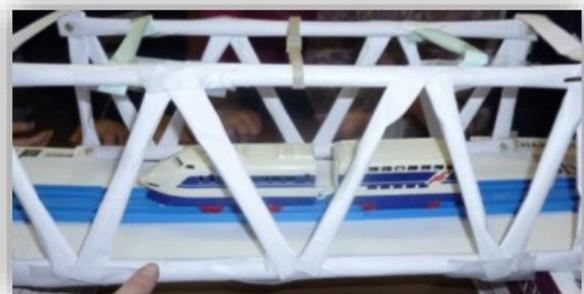
Selon la rigidité des cylindres, ils peuvent être utilisés comme poutres principales ou être pliés en forme de triangles ou de carrés avec des diagonales.
