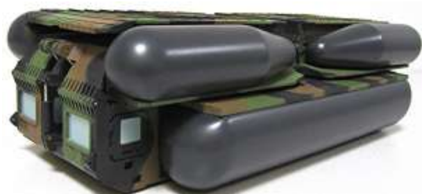
Roues rétractées, volets latéraux abaissés, flotteurs en cours de gonflage
