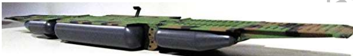
Bac prêt à l'emploi, rampes avant et arrières déployées, poste de pilotage amphibie activé sur la travure
